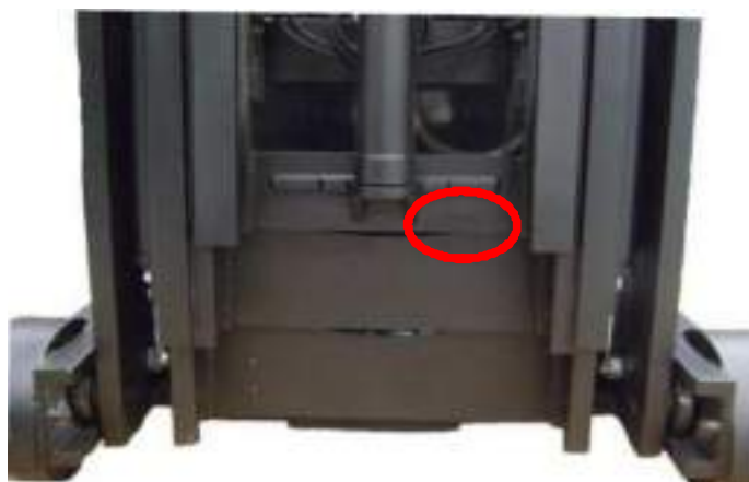
PLAQUETA DE Nº DE SÉRIE DA TORRE Elevar os garfos e verificar a plaqueta na travessa inferior.
