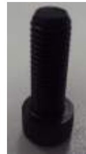
ALLEN M8 Torque = 18N.m
