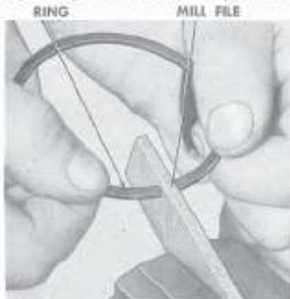
Fig. 14. Filing Ring Gap
