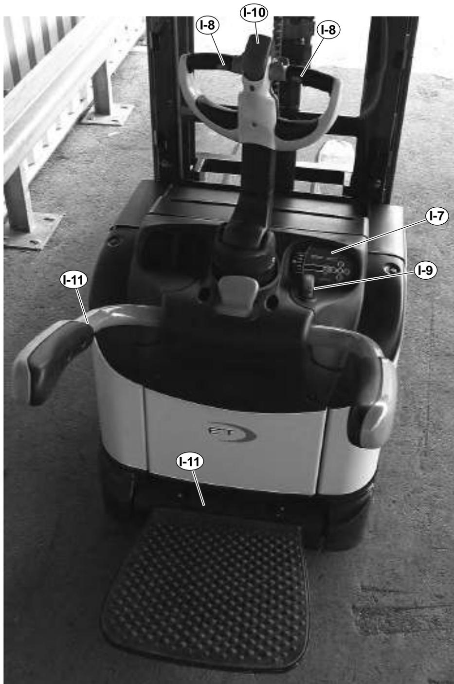
Abb. 8 Inspektionpunkte elektrisches System
