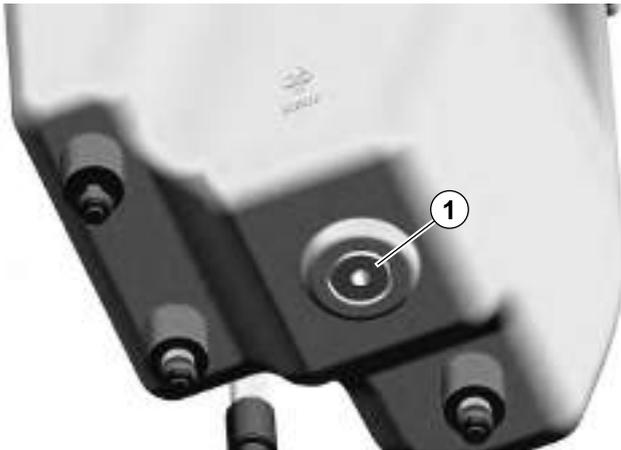
Abb. 17 Ölablass-Schraube
