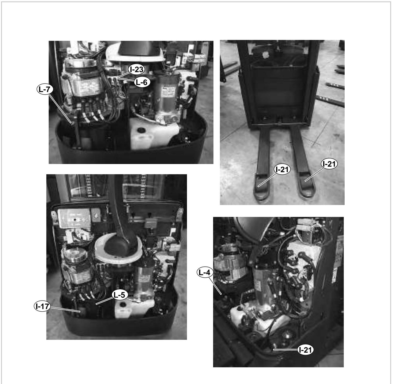
Abb. 10 Inspektions- und Schmierpunkte an Antrieb und Rädern
